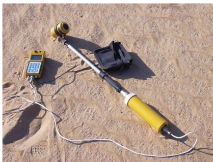
Квантовий магнітометр ПКМ-1, який використовується в археології.
